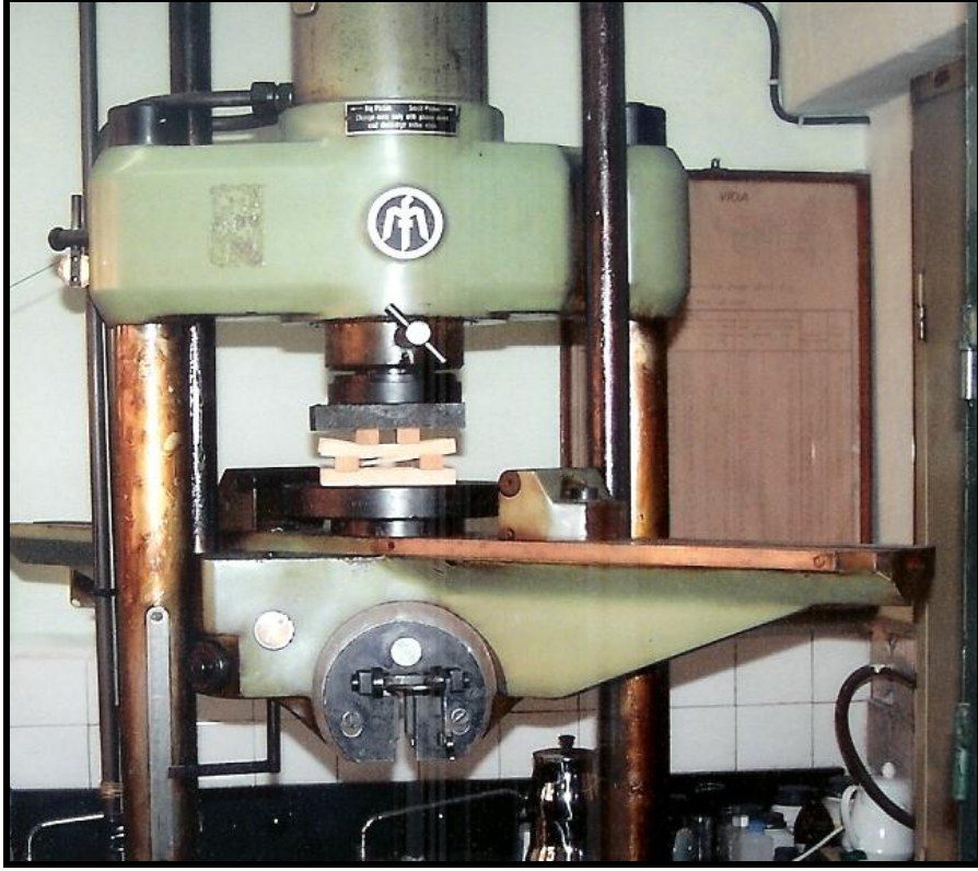
Şekil-10 MAZ Kalite Kontrol Baş Mühendisliği laboratuvarında çekme –basma deney seti
