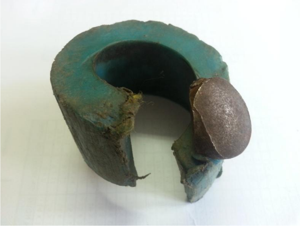
Şekil 23. Fren mekanizmasındaki hatalı montaja bir örnek. Tüp delik dışına fırlamış ve patlatma diski deşarz kafasından dışarı çıkarken sıkıştırma kovanına kaynak olmuş.
