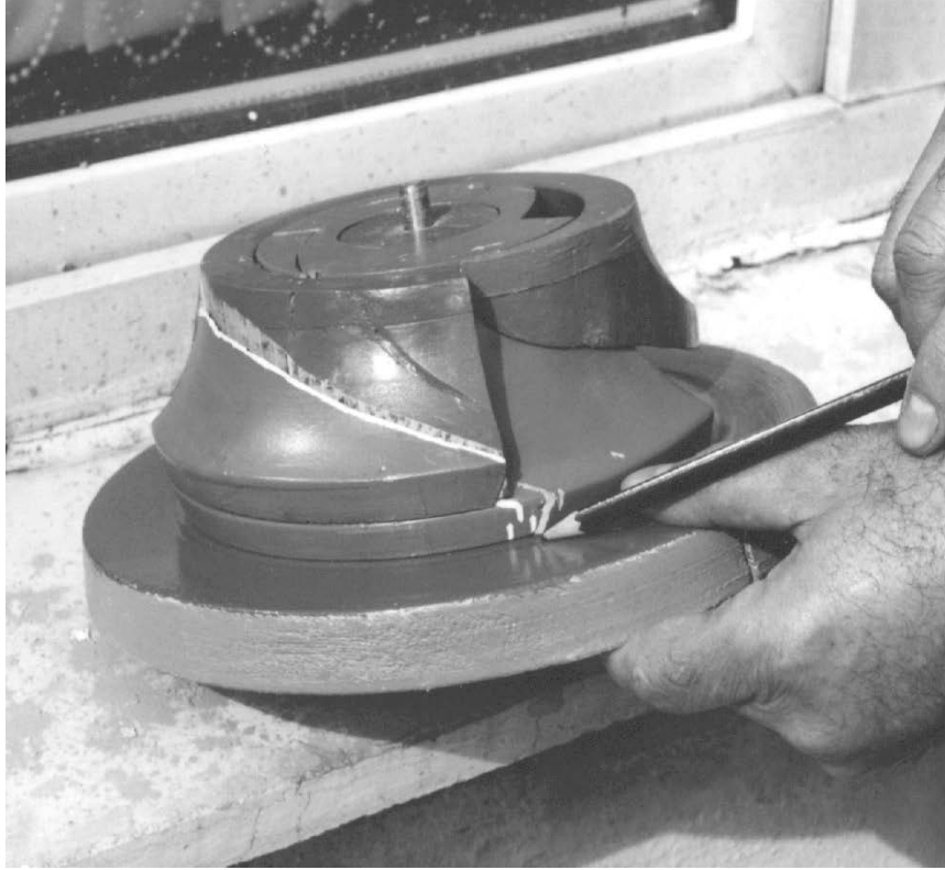
Şekil 7.7 - (i_o-i_t) ve (d_o-d_t) eğrilere karşılık gelen sapık kanat profillerinin birbirlerine göre konumu.
