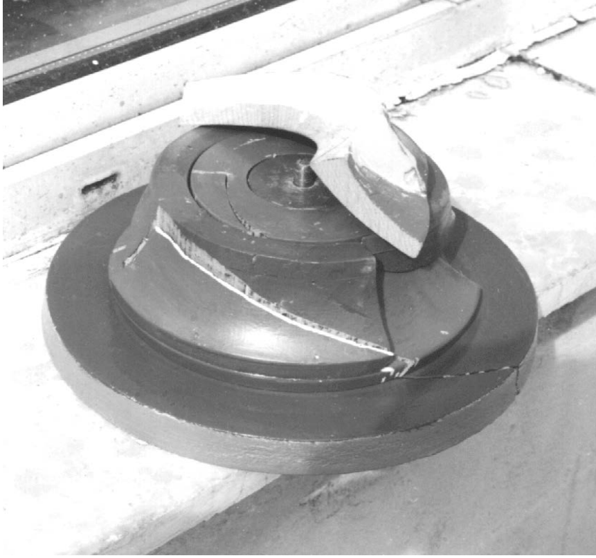
Şekil 7.5 - III parçası üzerinde, (d_o-d_t) eğrisine karşılık gelen profilin izi
