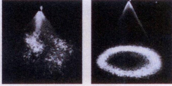
Şekil 6. Püskürtme (sprey) şekilleri içi dolu konik ve içi boş konik.
