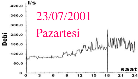
Şekil 2 : Değişken devirli (VSD) kompresörün haftalık çalışma diyagramları. (Atlas Copco,2001).
